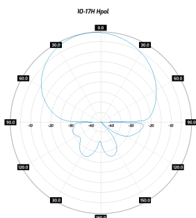
Radiation pattern WiBOX SA 5-90-17H Pol H
